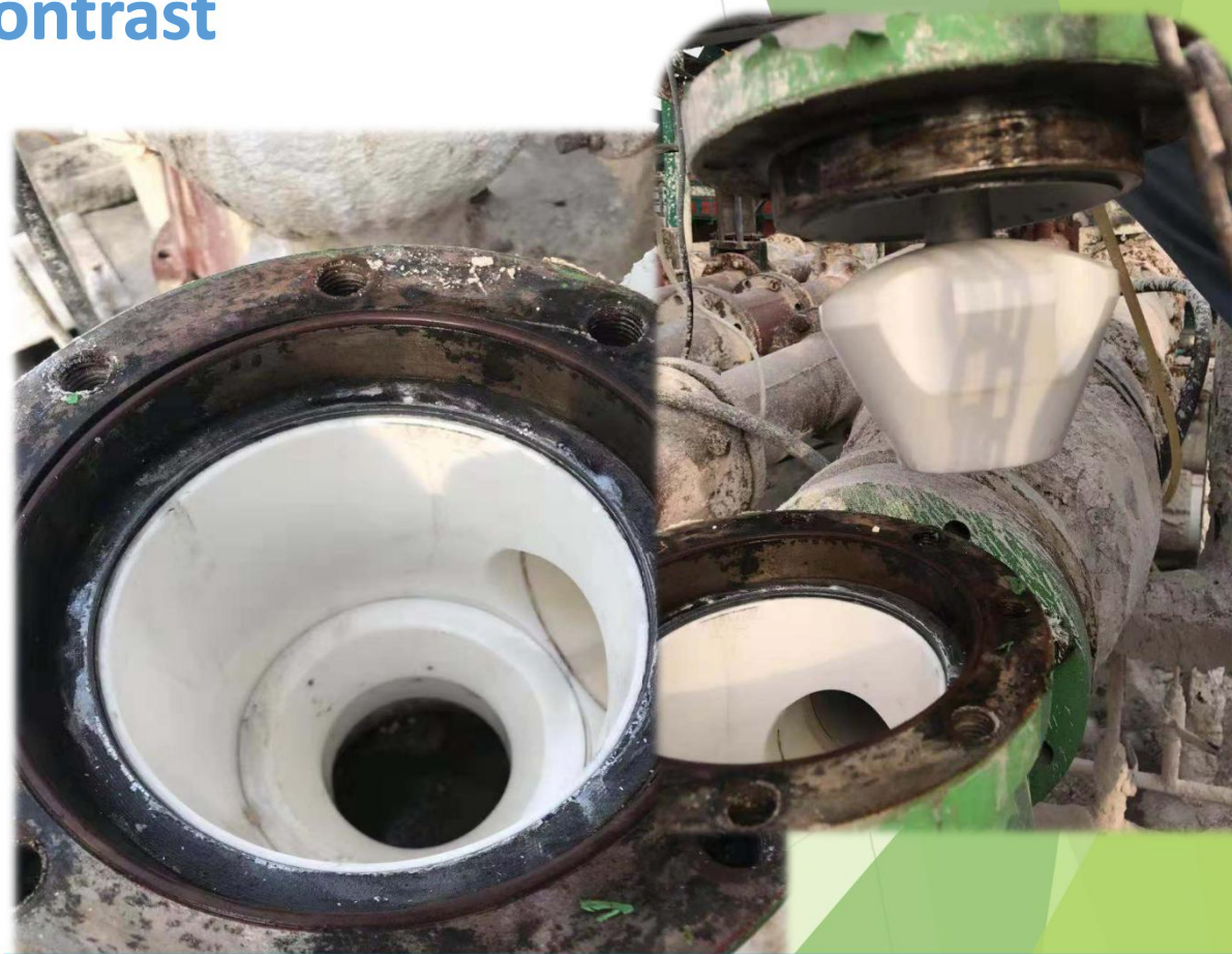
山野陶瓷角阀使用半年时 ceramic valve used half a year
