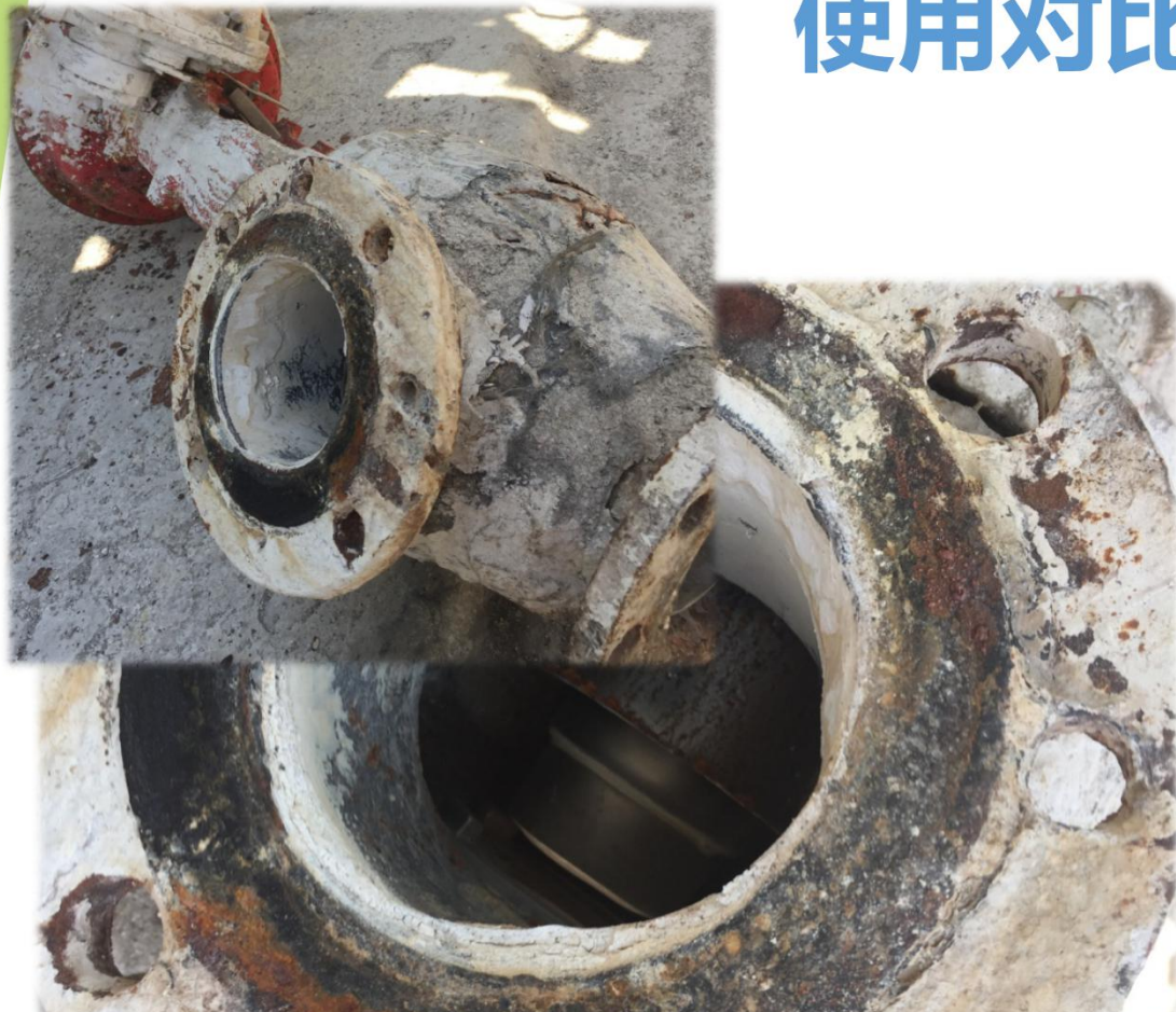
普通金属阀使用15天 normal valve used 15-day
